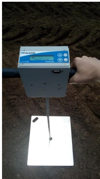
Figura 19 - Ensaio de RMSP com o penetrômetro eletrônico.
