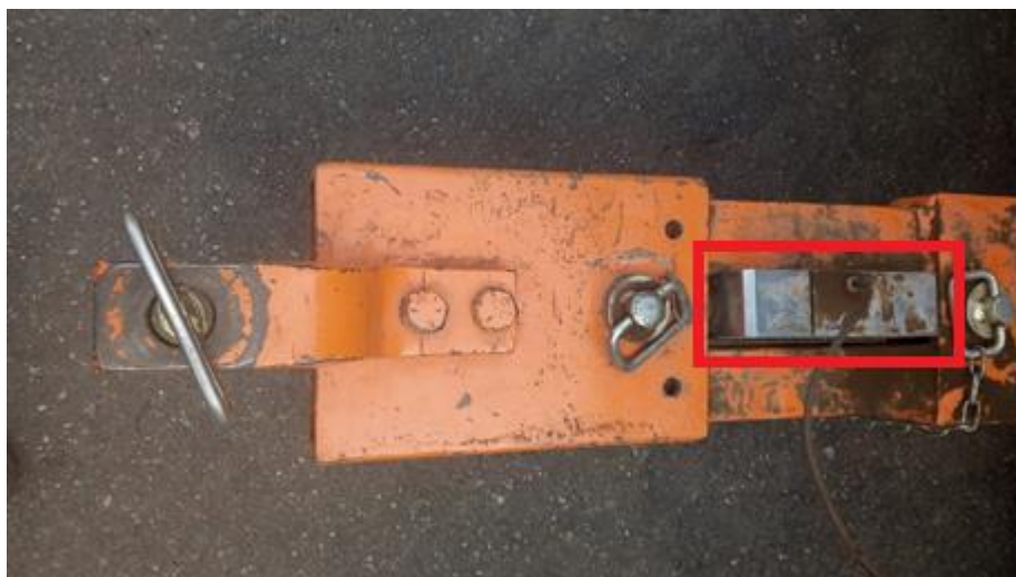
Figura 8 - Célula de carga acoplada na barra de tração.
