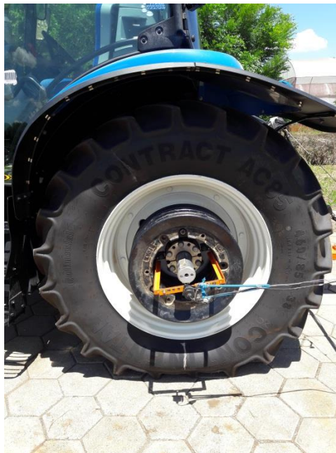
Figura 13 - Encoder no rodado traseiro.
