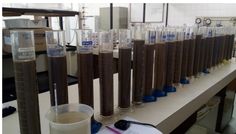
Figura 18 - Determinação da textura do solo pelo Método do Densímetro.
