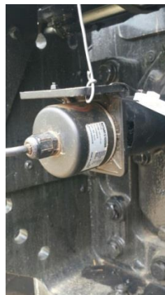
Figura 11 – Encoder instalado na TDP.
