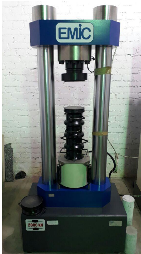
Figura 9 - Prensa hidráulica utilizada para calibração da célula de carga.
